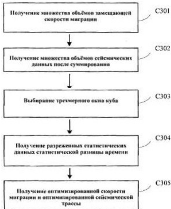
Фиг. 3. Блок-схема способа автоматического распознавания центра залежей в карстовых пещерах, согласно варианту реализации 4 описания настоящего раскрытия
