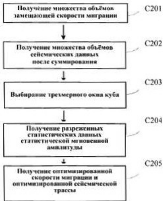
Фиг. 2. Блок-схема способа автоматического распознавания центра залежей в карстовых пещерах, согласно варианту реализации 3 описания настоящего раскрытия
