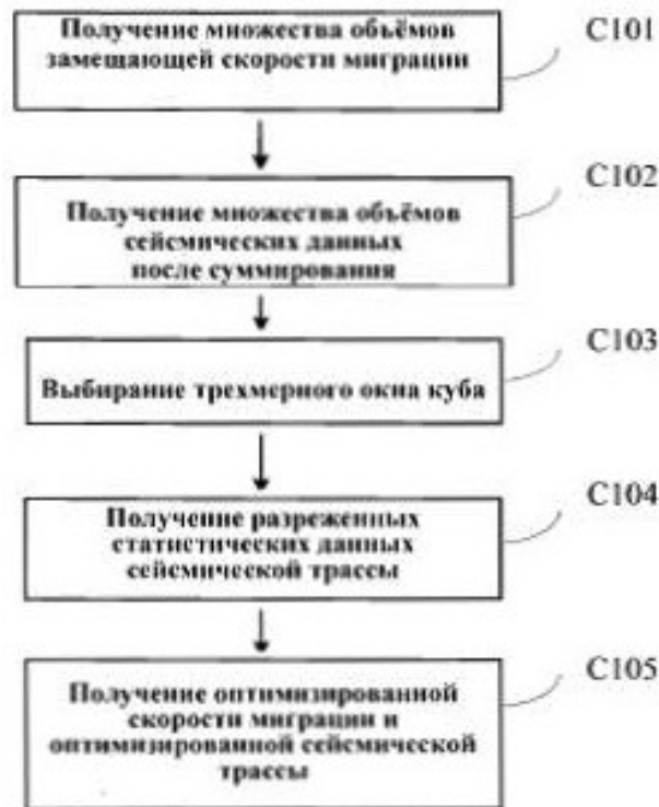
Фиг. 1. Блок-схема способа автоматического распознавания центра залежей в карстовых пещерах, согласно варианту реализации 1 описания настоящего раскрытия
