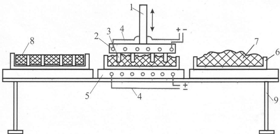
Фиг. 1. Пресс для формования строительного блока: 1 - шток; 2 - подвижная верхняя плита пресса;
